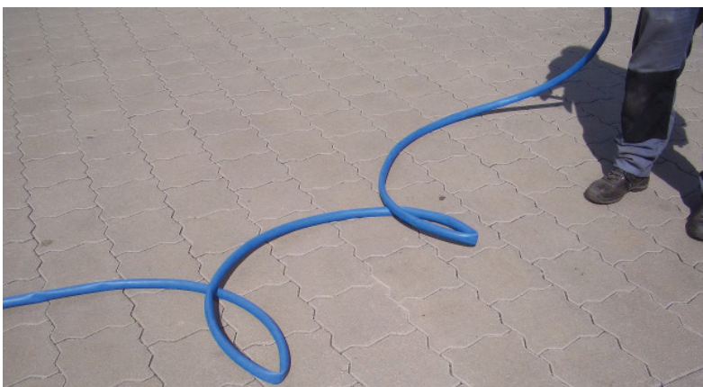
Schlauchknicke entstehen beim Abziehen von der Rolle!
